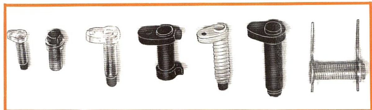
Fig. 6 - Le bobine possono essere avvolte « in aria », oppure su supporti di materiale isolante, muniti o meno di nucleo di ferrite. Quelli rappresentati in questa foto sono i supporti più comunemente adottati nell'elettronica moderna per la costruzione di bobine di tipo commerciale.
